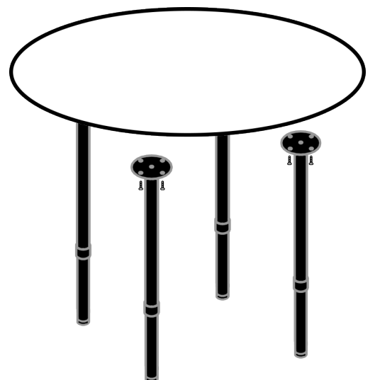
圖五：將调整好高度的桌腳使用六角螺絲與桌板上鎖固定
