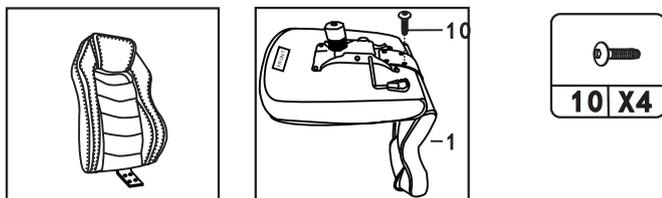
**步驟五** 依圖所示將扶手鎖入座椅背預留孔內
